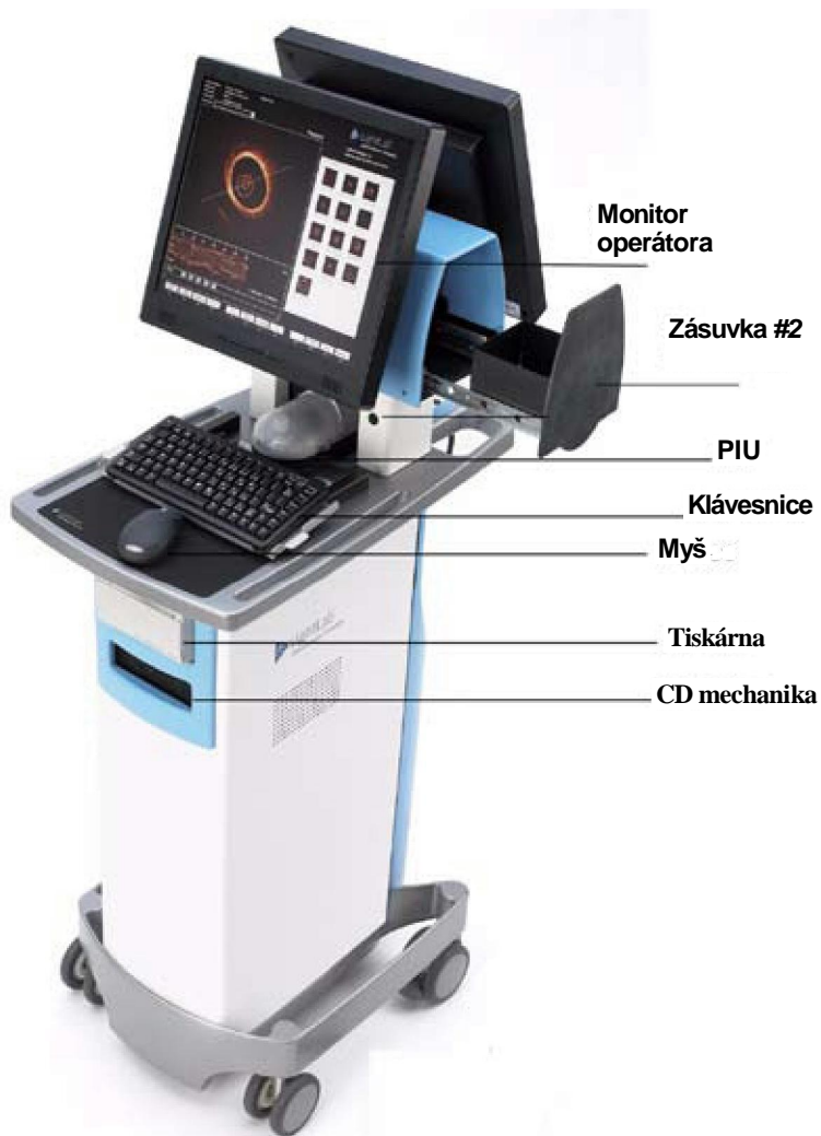
Obrázek 1-2: Systém na vozíku: strana pro operátora
