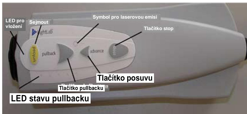
Obrázek 1- 4: Řídící motor a optický vazební prvek (DOC 2.0)
